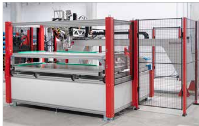
Centrum pro lepení skla a výrobu pěněního těsnění dveří rozvaděčů
